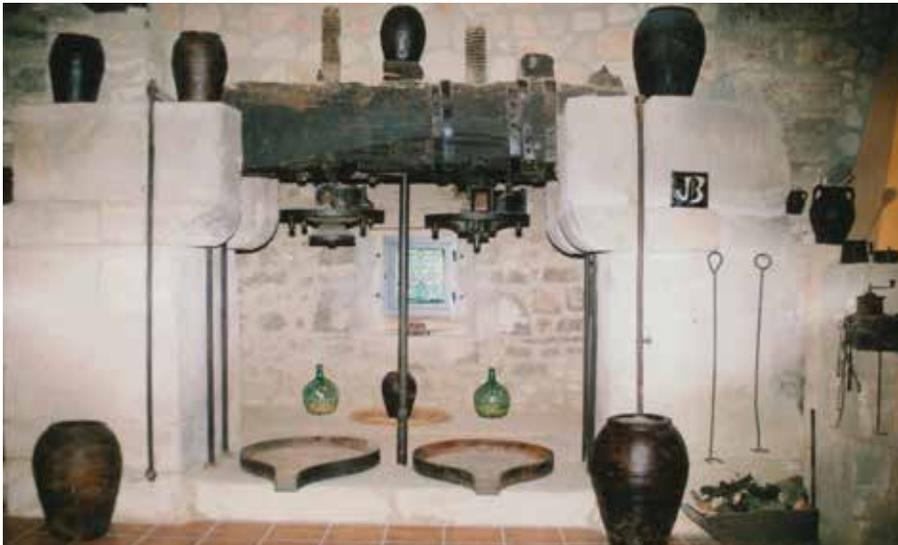
Fotografía 42: Prensa de capilla mediante husillos y torno.
