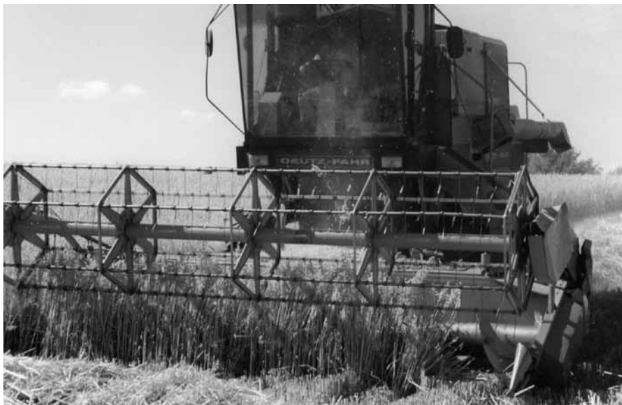
Foto detalle del corte de una cosechadora automotriz de cereal. Autor: Juanjo Galdos.
