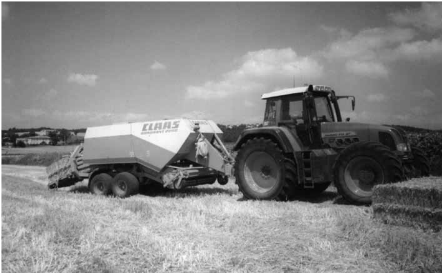
Enfardadora tirada por el tractor para recoger la paja en grandes fardos inmediatamente después de la cosecha del cereal. Autor: Juanjo Galdos.
