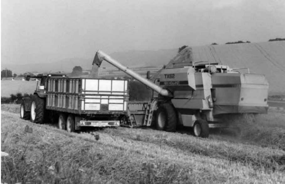
Cosechadora automotriz de cereal que corta la mies y separa el grano que deposita en un remolque sin detenerse en la labor. Autor: Juanjo Galdos.
