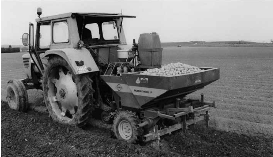
Imagen superior preparando la tierra para sembrar patatas con una máquina acaballadora que forma surcos llamados caballones. Imagen inferior sembrando patatas sobre los caballones. Autor: Juanjo Galdos.
