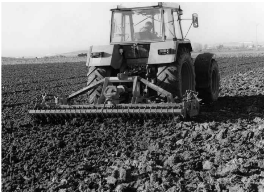
Labor de rastra sustituida por una máquina rotativa que prepara el terreno para la siembra. Autor: Juanjo Galdos.
