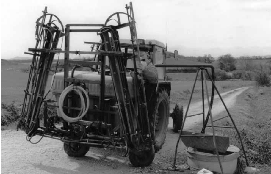
Llenando la caldera pulverizadora con agua mezclada con dosis de productos fitosanitarios. Autor: Juanjo Galdos.
