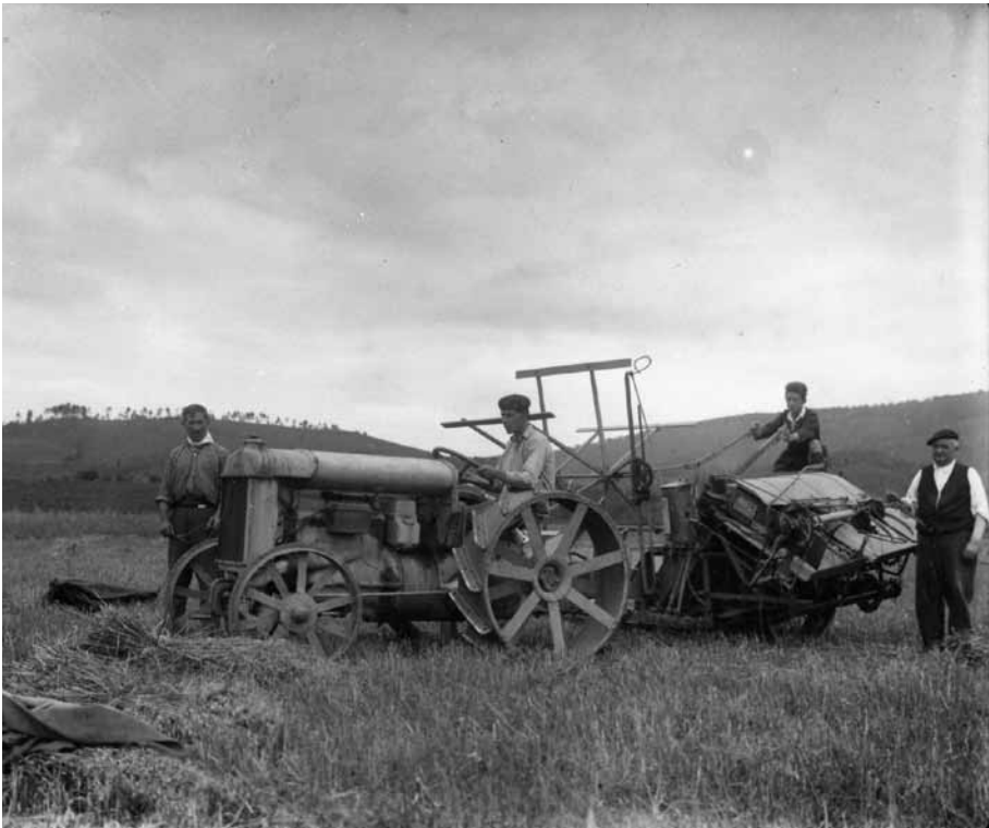
Tractor de ruedas de hierro, sin cubiertas de goma, que tira de una segadora atadora de cereal. Foto: Archivo Municipal de Vitoria-Gasteiz. Autor: Donato Sáez.
