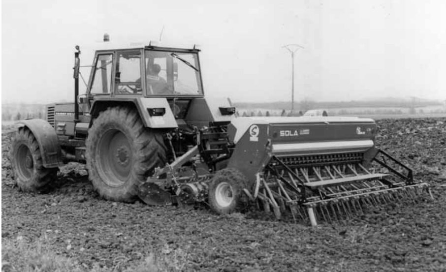
Siembra de cereal utilizando el tractor y una sembradora precedida de una rotativa que remueve la tierra. Autor: Juanjo Galdos.
